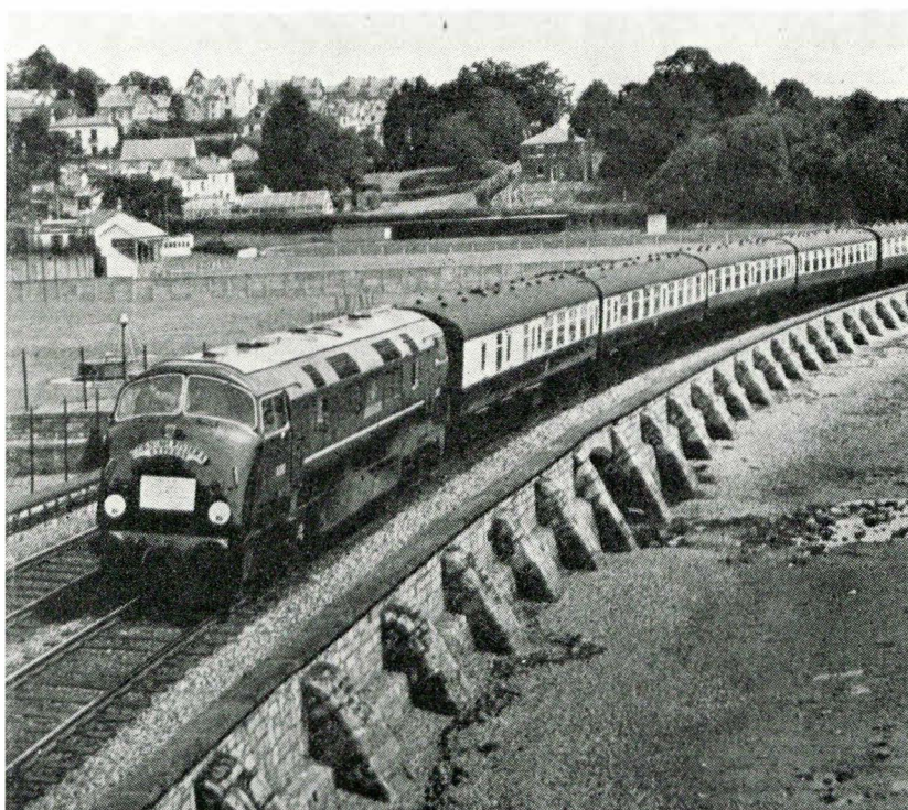
Dieselhydrauliske lokomotiver trækker mange af British Railways berømte tog. Her ser man et af dem, »Cornish Riviera«, hvis maskine er på 2.200 hk, og denne type lok bruges både til passager- og godstog.
